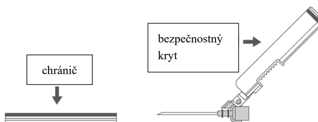
Obrázok C: Súčasti bezpečnostnej injekčnej ihly (pripravená na použitie)
