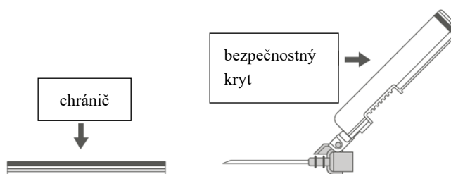
Obrázok C: Súčasti bezpečnostnej injekčnej ihly (pripravená na použitie)
