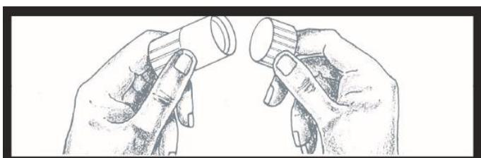
Ďalej odstraňte uzáver z protiprachového poťahu poistnej maticke luer odkrútením až po evidentné porušenie zapečatenia. Uzáver zahodťte.
